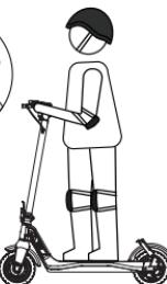
2. Sæt den ene fod op på løbehjulet, og sæt langsomt af med den anden fra jorden. Når løbehjulet begynder at rulle, skal du sætte begge fødder på løbehjulet og trykke på gashåndtaget. Motoren begynder at køre, når løbehjulets hastighed overstiger 5 km/t.
