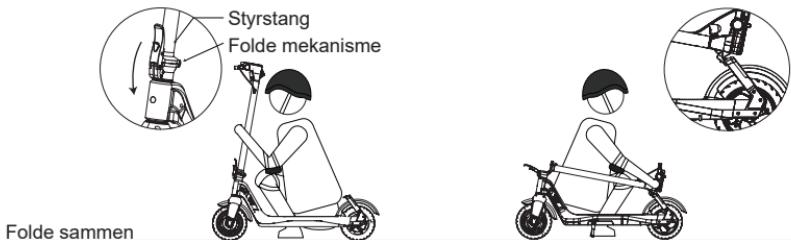
Kontroller, at løbehjulet er slukket. Lås folde håndtaget op, og vip styrestangen bagover mod spændet på bagskærmen for at fold løbehjulet sammen.
